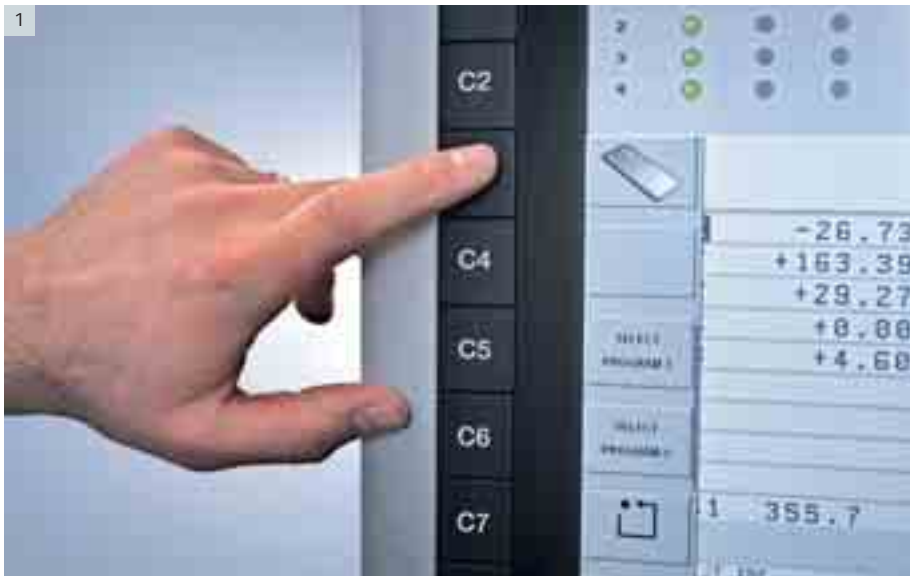
I1! 配有 DMG SOFTkeys® 的 DMG ERGoline® Control 控制面板 – 可以为经常使用的显示屏内容或操作序列随意设置快捷键 I2! DMG SMARTkey® – 电子化访问控制, 个性化授权, 为不同的操作员赋予相应的控制系统和机床的访问权限
